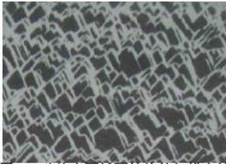
图 4-5 硅片表面绒面结构的扫描电镜图
