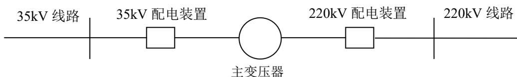
图 2-5 新建 220kV 升压站简易系统示意图
