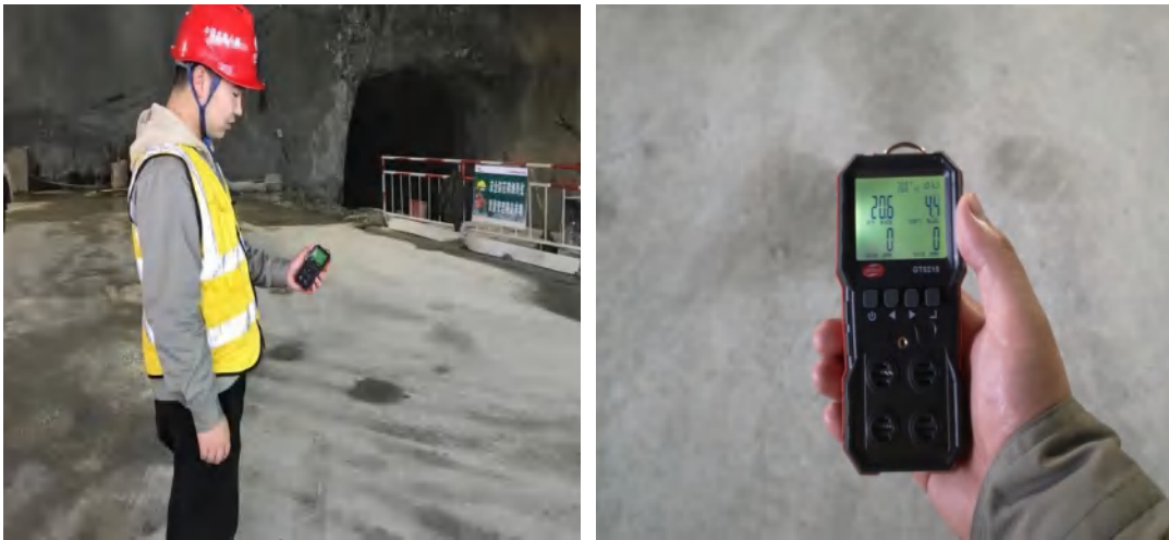
洞室空气质量检测
